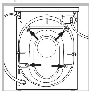
3. Enlever les vis de protection servant au transport, le caoutchouc et la cale, placés dans la partie arrière (voir figure).
