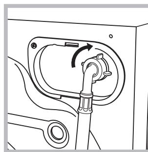
2. Raccorder le tuyau d'arrivée de l'eau au lave-linge en le vissant à la prise d'eau prévue, dans la partie arrière en haut à droite (voir figure).
