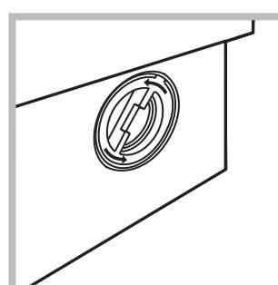
2. Odskrutkujte veko otáčaním proti smeru hodinových ručičiek (*vid' obrázok*): výtečenie malého množstva vody je úplne bežným javom;
