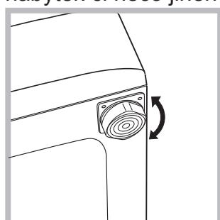
Dokonalé vyrovnání do vodorovné polohy zabezpečí stabilitu zařízení a zamezí vzniku vibrací a hluku během činnosti. V případě instalace na podlahovou krytinu nebo na koberec nastavte nožky tak, aby pod pračkou zůstal dostatečný volný prostor pro ventilaci.
