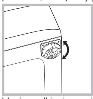
2. Jeśli podłoga nie jest idealnie pozioma, należy skompensować nierówności, odkręcając lub dokręcając przednie nóżki (patrz rysunek); kąt nachylenia, zmierzony na górnym blacie pralki, nie powinien przekraczać 2°.
