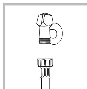
1. Pripojte prívodnú hadicu jej zaskrutkováním ku kohútiku so studenou vodou, s hrndlom so závitom 3/4" (viď obrázok). Pred pripojením hadice nechajte vodu odtieť, až kým nebudete číra.
