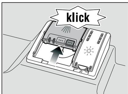
Komora pro mycí prostředek se otevře v závislosti na programu automaticky ve správném okamžiku. Práškový nebo tekutý mycí prostředek se ve spotřebiči rozdělí a rozpustí, tableta spadne do záchytné přihrádky, kde se postupně rozpustí.
