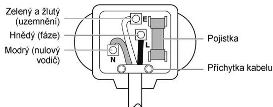
Protože barvy vodičů napájecího kabelu tohoto přístroje nemusí odpovídat barevnému označení koncovek vaší zástrčky, postupujte následujícím způsobem:
