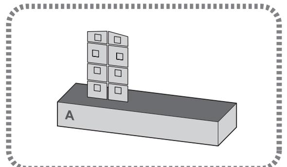
IT Fissaggio con biadesivo EN Securing with double-sided tape
