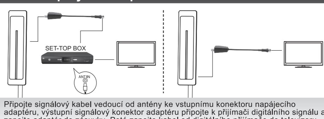
Připojte signálový kabel vedoucí od antény ke vstupnímu konektoru napájecího adaptéru, výstupní signálový konektor adaptéru připojte k přijímači digitálního signálu a zapojte adaptér do zásuvky. Poté zapojte kabel od digitálního přijímače do televizoru.
