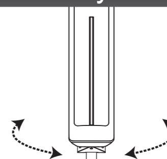
Otačajte anténou a sledujte kvalitu obrazu, po nalezení polohy s najlepším signálom a obrazom anténu v polohe zaistite.
