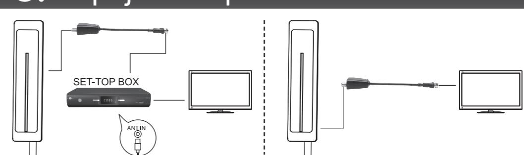
Pripojte signálový kábel vedúci od antény k vstupnému konektoru napájacieho adaptéra, výstupný signálový konektor adaptéra pripojte k prijímaču digitálneho signálu a zapojte adaptér do zásuvky. Potom zapojte kábel od digitálneho prijímača do televízoru.
