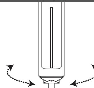
Otačejte anténou a sledujte kvalitu obrazu, po nalezení polohy s nejlepším signálem a obrazem anténu v poloze zajistěte.
