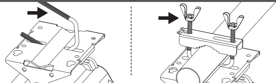
Vložte strmeňovú skrutku do otvoru v držiaku antény a nasadte na neho sponu.
