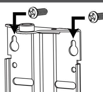
Podľa polohy otvorov v držiaku antény vyvŕtajte do múru otvory a upevnite skrutky. Na skrutky nasadte držiak antény a dotiahnite.
