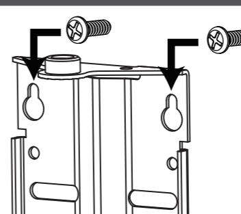
Podle polohy otvorů v držáku antény vyvrtěte do zdi otvory a upevněte šrouby. Na šrouby nasadte držák antény a dotáhněte.
