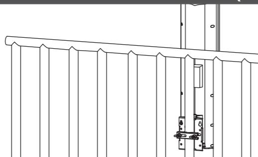
Pomocou strmeňové skrutky pripojené držiak antény k zábradliu a utiahnite skrutky.
