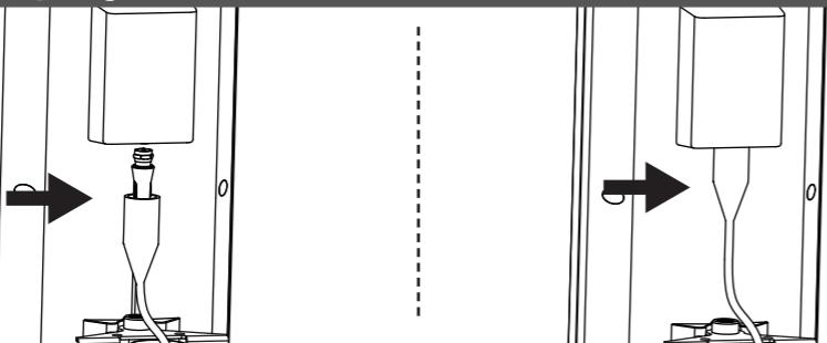
Připojte signálový kabel k anténnímu výstupu a přetáhněte přes něj vodotěsnou krytku.
