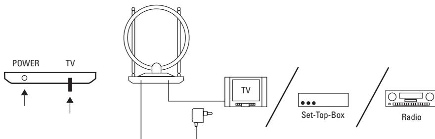
3) Включение Вкл. [ON] / Выкл. [OFF] и регулировка усиления
