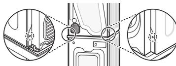
3 Zarovnejte otvory spojovací sady LG s otvory v zadním krytu.
