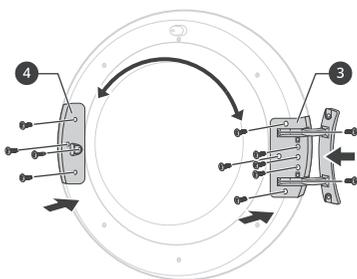
**5** Odstraněním 2 šroubků sundejte uchycení dvířek **5** z rámu spotřebiče a poté ho namontujte na opačnou stranu.
