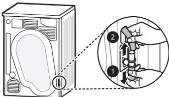
**2** Nasadte kryt proti zpětnému toku **1** na horní část připojovacího kolene nebo spojky a poté připojte volitelnou odtokovou hadici **3** ke
