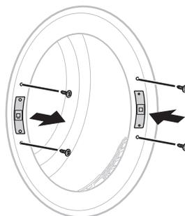
**7** Nainstalujte dvířka pomocí šroubků odstraněných v kroku č. 1 a poté zkontrolujte, že se dvířka správně zavírají.
