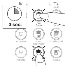
**2** Na 3 vteřiny současně stiskněte tlačítko Horká péna + Cappuccino, čímž přejdete do nabídky Nastavení automatické úspory energie: rozsvítí se výstražné kontrolky „descaling“ a „clean“ a tlačítka Horká péna, Latte Macchiato a Cappuccino začnou blikat.
