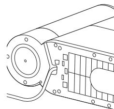
**2** Kábel umiestnite na pravú alebo ľavú stranu zariadenia (podľa vášho želania) pomocou krytu určeného na tento účel pod zariadením.
