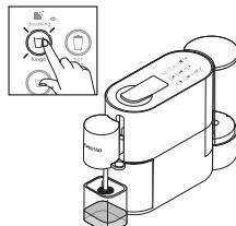
❼ Stlačte tlačidlo Lungo na opláchnutie zariadenia. Tento postup opakujte trikrát. Potom stlačte tlačidlo Hot Foam (Horúca pena) na vyčistenie parného okruhu. Zariadenie je pripravené na použitie.
