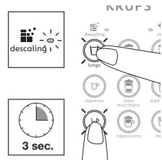
⑥ Do nabídky odvápnění se dostanete tak, že na 3 vteřiny současně stiskněte tlačítka Lungo + Ristretto. Obě tlačítka začnou blikat. Pro spuštění programu odvápnění stiskněte znovu stejná tlačítka.
