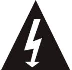
Tento symbol upozorňuje na nebezpečná napětí představující riziko úrazu elektrickým proudem přítomná v tomto zařízení.
