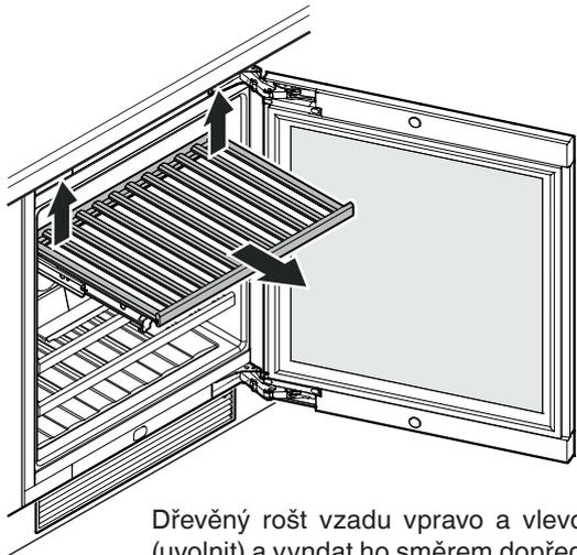
Dřevěný rošt vzadu vpravo a vlevo nadzvednout (uvolnit) a vyndat ho směrem dopředu.
