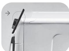
**V prípade že nepoznáte pozíciu NFC antény, krúživými pohybmi ľahko pohybujte smart telefónom nad logom One Touch až kým aplikácia nepotvrdí pripojenie. Aby bol prenos dát úspešný, JE NUTNÉ UDRŽIAVAT SMART TELEFÓN V BLÍZKOSTI OVLÁDACIEHO PANELU POČAS CELÉHO NIEKOĽKOSEKUNDOVÉHO PRIPOJENIA.** Následne Vás bude zariadenie informovať o správnom výsledku operácie a oznámi Vám, že je možné presunúť sa so smart telefónom kamkoľvek.
