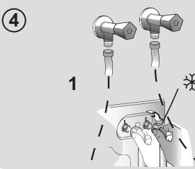
**HOT&COLD (εικ. 4):** πρόβλεψη για σύνδεση τόσο με το δίκτυο ζεστού όσο και με το δίκτυο κρύου νερού για μεγαλύτερη εξοικονόμηση ενέργειας. Συνδέστε τη γκρι σωλήνα στη βρύση του κρύου νερού και την κόκκινη σωλήνα στην βρύση του ζεστού νερού. Η συσκευή μπορεί να συνδεθεί και αποκλειστικά μόνο στη βρύση κρύου νερού ή μόνο στη βρύση ζεστού, σε αυτή την περίπτωση η έναρξη κάποιων προγραμμάτων θα καθυστερήσει για μερικά λεπτά.
