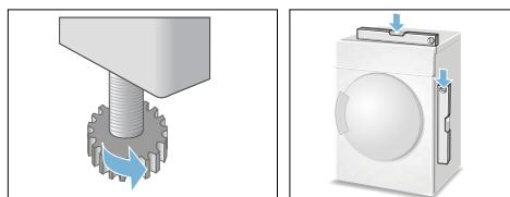
Chybne vyrovnání může způsobit hlasité zvuky, vibrace a chybny pohyb bubnu.
