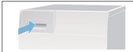
**Upozornění:** Sítko v nádržce na kondenzovanou vodu filzuje kondenzovanou vodu, která se používá pro automatické čistění sušičky. Sítko se čistí vyprázdněním kondenzované vody. Přesto sítko pravidelně kontrolujte, zda v něm nejsou usazené nečistoty a odstraňte je. Viz → Strana 34.
