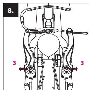
Pokud kolo při otáčení v některém místě škráta o brzdový špalík, symetricky upravte vzdálenost brzdových ramen napínacími šroubkami (3).
