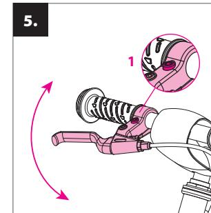
**Nastavitev zavornih ročic:** pravilen naklon zavornih ročic nastavite s pomočjo pritrtilnega vijaka na objemki (1).
