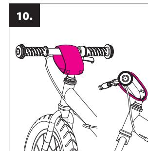
**Montiranje zaštite:** na šipku upravljača pričvrstite mehani zaštitni pokrov od perivača najlona.
