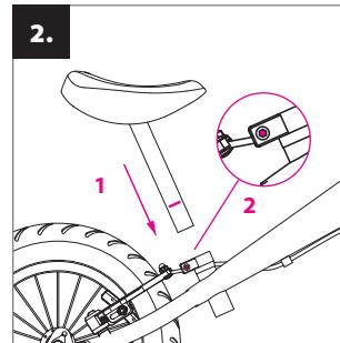
**Instalacja siodła:** wsuń sztycę podsiodłową do ramy rowerka biegowego (1), ustaw żądaną wysokość siodła (maks. do zaznaczonej linii) i dokręć śrubę na obejmie (2).
