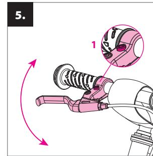
**Namještanje ručica kočnica:** namjestite pravilan nagib ručica kočnica pomoću pričvrstog vijka na obujmici (1).
