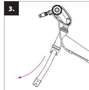
**Montaż przedniego koła:** należy sprawdzić, czy przedni widelec rowerka biegowego jest obrócony we właściwym kierunku (lekkie wygięcie jest skierowane do przodu) i dokręcić śrubę na obejmie (2).
