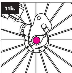
Spodní úchyt naopak umožní nastavit sedlo výše než je běžné. Pozor: po každé změně polohy zadního kolečka znova seřídeť brzdy.
