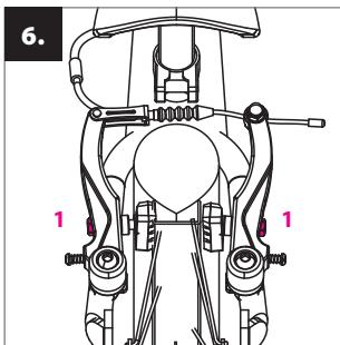
**Seřízení brzdy:** před seřízením brzdy nahustěte pneumatiky dle hodnot na boku pláště (ideálně mezi 1,3 – 1,8 bary). Zkontrolujte, zda brzdové špalíky při zabrzdění dosedají celou svou plochou na bok ráfku. Jejich polohu můžete upravit pomocí šroubek (1). Špalíky se nesmí dotýkat pláště.
