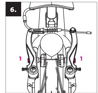
**Fék beállítása:** a fékek beállítása előtt a gumiabroncsokat fűjje fel a köpeny oldalán megjelölt értékeknek megfelelően (1,3 és 1,8 bar között ideális)! Ellenőrizze, hogy a fékpofák fekezéskor teljes felületükkel rásimulnak-e a felnői oldalára! Helyzetük csavarok segítségével állítható (1). A fékpofák nem érintkezhetnek a gumiköppennel.
