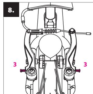
Pokiaľ sa koleso pri otáčaní v niektorom mieste dotýka brzdrovej doštičky, upravte symetricky vzdialenosť brzdrových ramien napínaními skrutkami (3).
