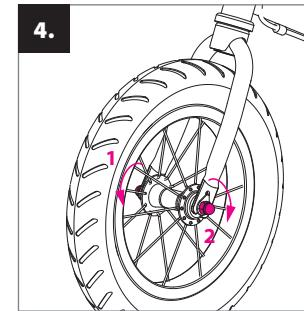
Nakon toga stavite u vilicu kotač tako da je točno u sredini i pritegnite matice (1, 2). (Radi lakšeg montiranja guralicu možete postaviti u poziciju naglavačke).
