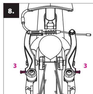
Jeżeli koło podczas obracania się styka w некоторym miejscu z klocką hamulcowego, należy symetrycznie dostosować odległość ramion hamulca za pomocą śrubek do napinania (3).
