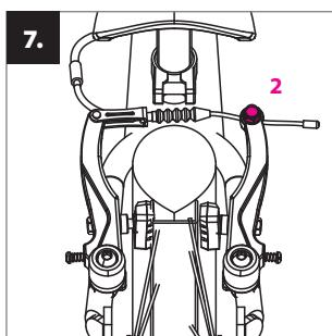
Sprawdź, czy po zwolnieniu dźwigni hamulca klocki wystarczająco odsuną się od obręczy (1 - 2 mm). Odległość klocków można dostosować poprzez dociągnięcie lub poluzowanie linki hamulcowej w śrubie mocującej (2).
