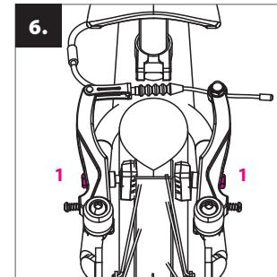
**Nastavitev zavore:** pred nastavljanjem zavore napolnite gume po napotkih navedenih na plasču (idejalno med 1,3 – 1,8 bar). Preverite, ali se zavorne obloge med zaviranjem z vso površino »usedejo« na bočnico platišča. Njihov položaj lahko spreminjate s pomočjo vijakov (1). Obloge se ne smejo dotikati plastične.
