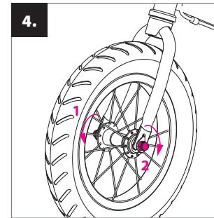
Vložte koleso do vidlice tak, aby bolo presne uprostred a dotiahnite matice (1, 2). (Pre uľahčenie montáže môžete odrážadlo otočiť "hore nohami").
