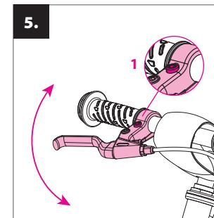
**Seřízení brzdových pácek:** nastavte správný sklon brzdových pácek pomocí upevňovacího šroubu na objímce (1).
