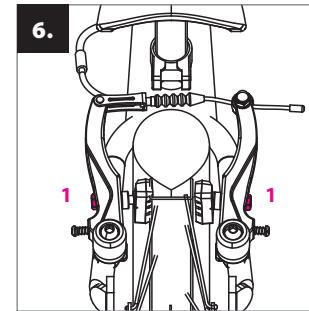
**Namještanje kočnice:** prije namještanja kočnica potrebno je napuhati gume prema vrijednosti ma na boku plašta (idealno između 1,3 – 1,8 bara). Provjerite da li se blokovi kočnica cijelom svojom površinom dodiruju bočne strane naplatka. Njihovu poziciju možete prilagoditi pomoći vijaka (1). Blokovi se ne smiju dodirivati plašta.
