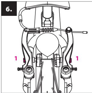
**Nastavenie brzdy:** pred nastavením bŕzd nahustite pneumatiky na hodnoty uvedené na boku plášťa (ideálne medzi 1,3 – 1,8 baru). skontrolujte, či brzdrové doštičky dosadajú na ráfik celou svojou plochou. Ich polohu môžete upraviť pomocou skrutiek (1). Brzdrové doštičky sa nesmú dotýkať plášťa!
