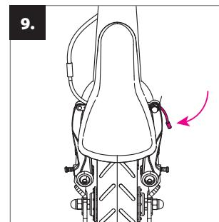
Koniec brzdrového lanka zahnite tak, aby neprekážal pri jazde.
