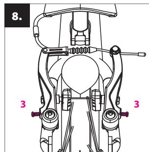
Ako se kotač prilikom okretanja na nekom mjestu dodiruje blok kočnice, simetrično podesite udaljenost krakova kočnica vijcima za napinjanje (3).
