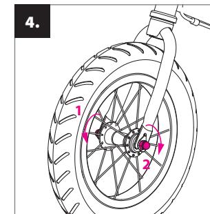
Poté do vidlice vsaďte kolo tak, aby bylo přesně uprostřed a dotáhněte matice (1, 2). (Pro usnadnění montáže můžete odrážedlo překlopit do polohy vzhůru nohama).
