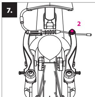
Provjerite da li se blokovi nakon puštanja ručice kočnice dovoljno odmaknu od naplatka (1-2 mm). Udaljenost blokova može se podesiti stezanjem ili popuštanjem kočnice užeta u sidrenom viju (2).
