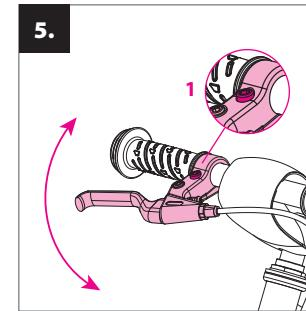
**Nastavenie brzdrových páčiek:** nastavte správny sklon brzdrových páčiek pomocou upevňovacej skrutky na objímke (1).
