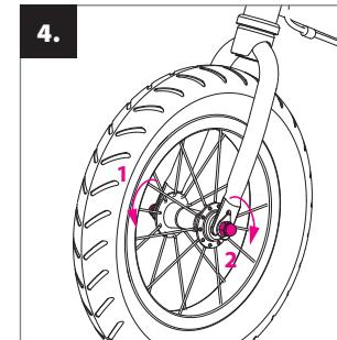
Następnie włóż koło do widełka tak, aby znajdowało się ono dokładnie w środku i dokręcić nakrętki (1, 2). (Dla ułatwienia montażu można rowerek biegowy odwrócić do góry nogami).
